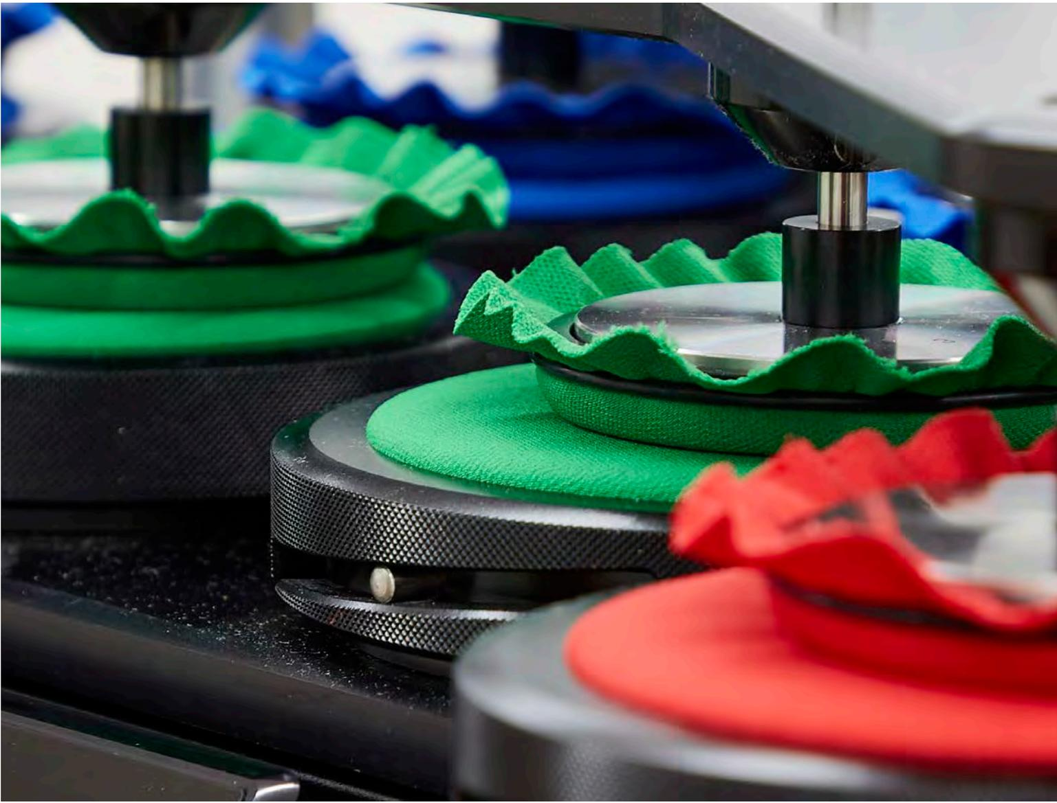
Die Martindale-Maschinen laufen rund um die Uhr. Mit den Maschinen wurden die Strapazierfähigkeit des Gewebes und die Pillingneigung getestet.
